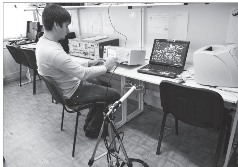
Лаборатория технических средств защиты информации. Оценка уровней побочных электромагнитных излучений ноутбуков.
